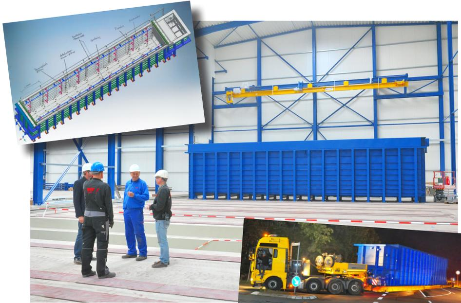
einschlüsse am Bauteil sorgt, besteht aus einem System von insgesamt 58 Düsen an sieben Leitungsrohren mit einer Gesamtlauflänge von 116 Metern. Sie erstrecken sich über Dimensionen des KTL-Beckens von 21 Meter Länge inklusive Überlauf, 3,40 Meter Breite und 4,60 Meter Höhe.
